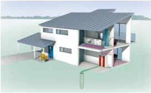
Schema einer Sole/Wasser-Wärmepumpe
