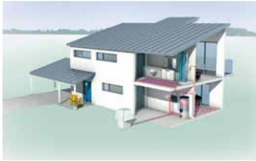
Schema einer Luft/Wasser-Wärmepumpe
