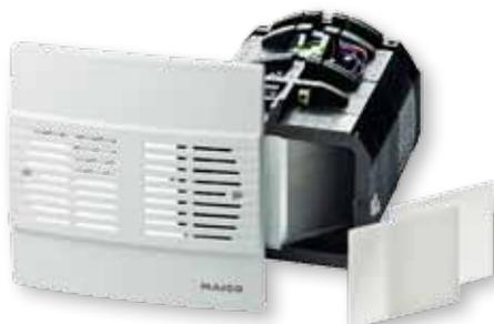
Der WRG 35 bietet aber nicht nur die kontrollierte Be- und Entlüftung, sondern auch eine energieeffiziente Wärmerückgewinnung: Dabei wird die Wärme der Abluft über den integrierten Aluminium-Kreuzstrom-Wärmetauscher zu über 70 Prozent wieder an die angesaugte frische Luft abgegeben. Das Ergebnis ist ein gesundes, behagliches Wohnklima mit Energiespar-Effekt. Außerdem werden so Schimmelbildung und Gebäudeschäden vermieden.
